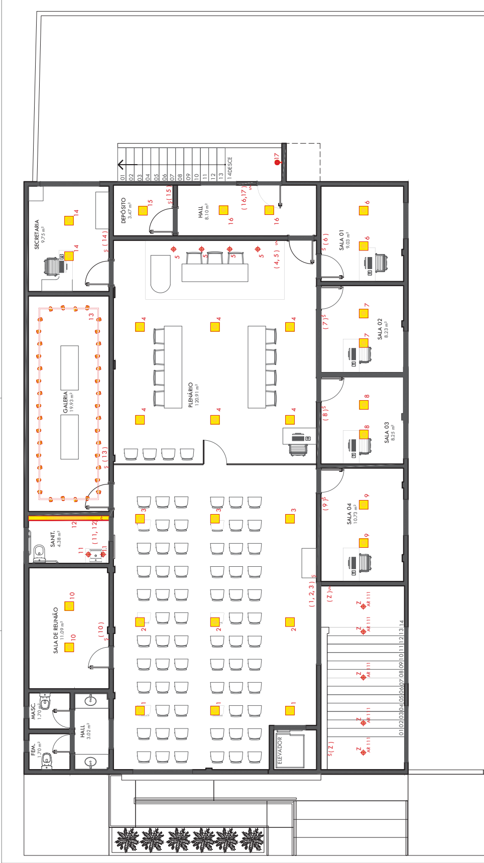
PLANTA DE ILUMINAÇÃO CIRCUITOS - SUPERIOR ESC.: 1/75
